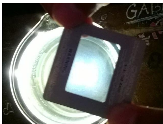
Figura 3.13 - Análise da rotação do plano de polarização (atividade óptica) por solução de sacarose (açúcar). Fonte: autor.
