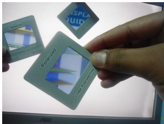
Figura 3.12 - Visualização da imagem monitor LCD sem polarizador através de filtros polarizador. Fonte: autor.
